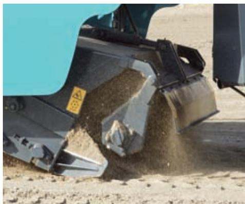
El rodillo recogedor transfiere la suciedad a la cinta de tamizado. La posición del rodillo recogedor y el ajuste de la profundidad de las rejillas receptoras se adaptan a la consistencia de la arena.
