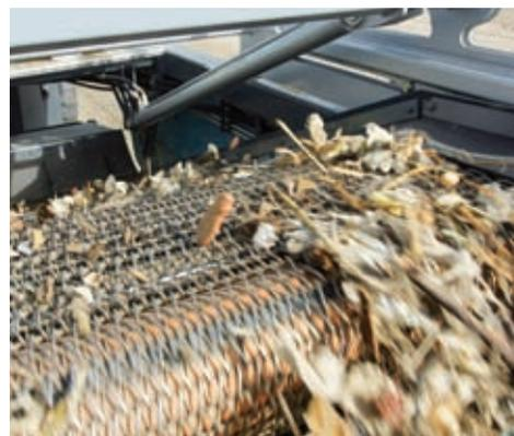
Los desechos se transfieren, libres de arena, de la cinta de tamizado al depósito colector. Todas las funciones están dotadas de un sistema de seguridad. En caso de producirse una sobrecarga o un manejo incorrecto suena una señal acústica de advertencia.
