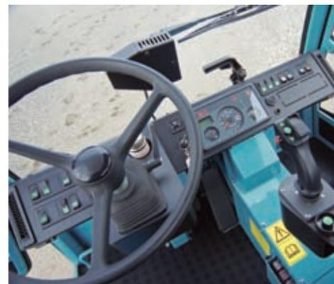
El puesto de conducción y la palanca de mando, de diseño ergonómico, facilitan el manejo. Práctico: el espejo de gran tamaño y regulación eléctrica, y la excelente visibilidad omnidireccional. La confortable cabina del conductor de dos plazas puede solicitarse con techo abatible y aire acondicionado.
