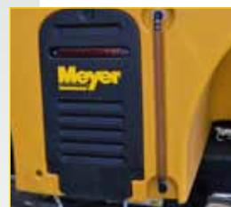
**Carcasa de protección trasera** para el motor eléctrico que le preserve de la acción corrosiva de la sal sin herramientas.
