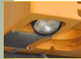
**Luz de trabajo integrada** ilumina el área de extendido y ayuda a las operaciones de mantenimiento. Luz LED estandar en modelos DLX y alogóeno en modelo estandar.
