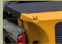
**Lona en la parte superior** de la tolva de fácil y rápida instalación. Estandar en el modelo DLX.
